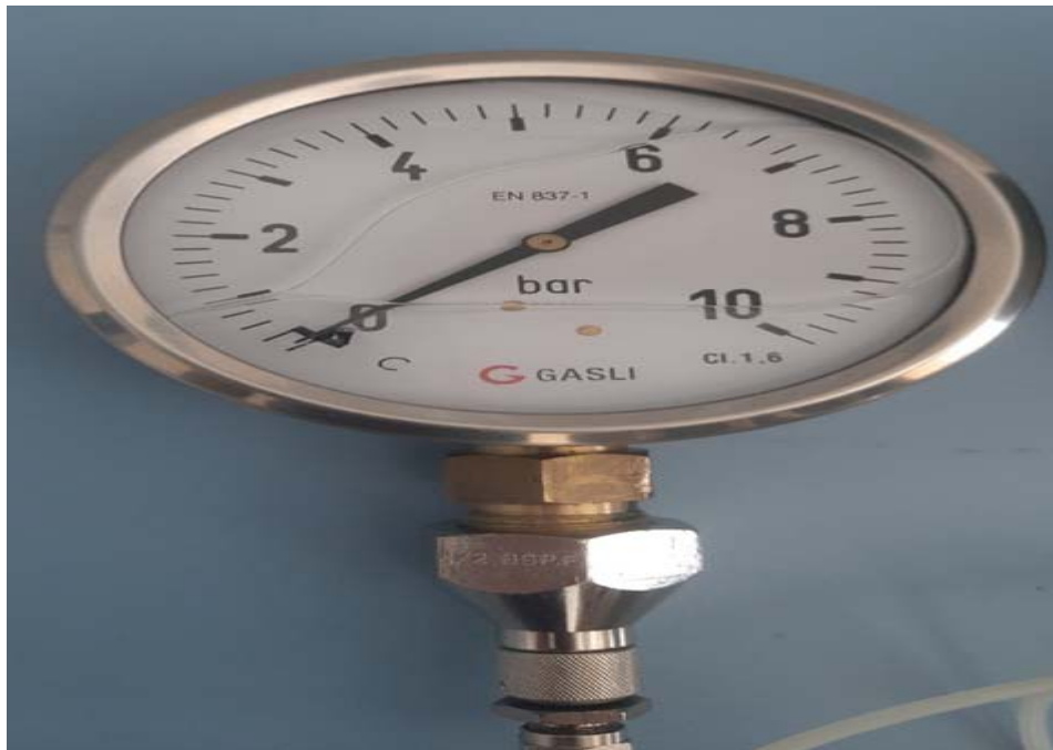
Figure III.11 : Manomètre métallique avec étendue de mesure (0-10bar).
