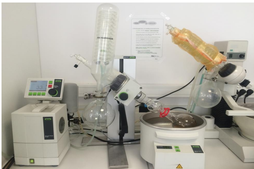
Figure II. 7 : Le dispositif de distillation par évaporation
