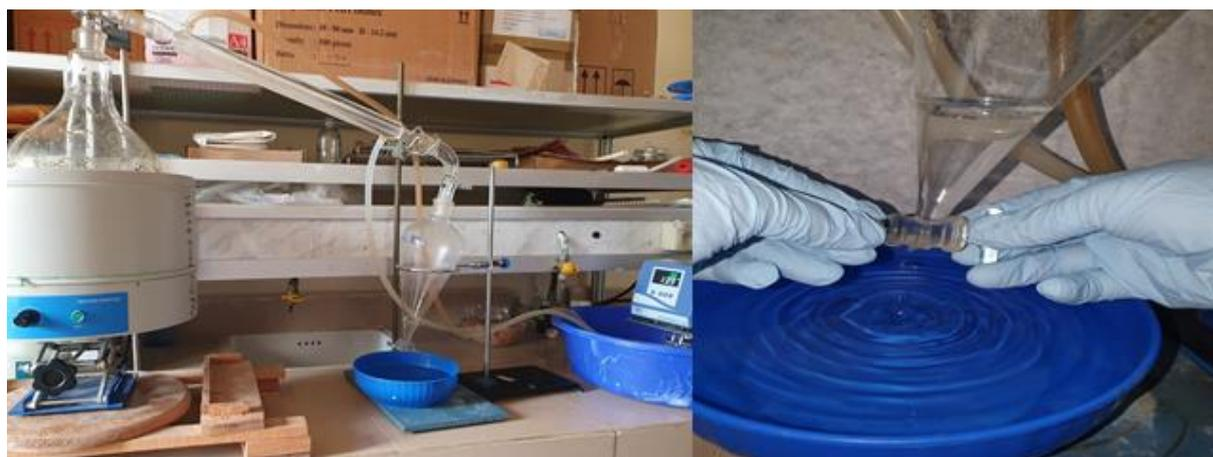
Figure 9 : Dispositif d'extraction des HE par hydrodistillation
