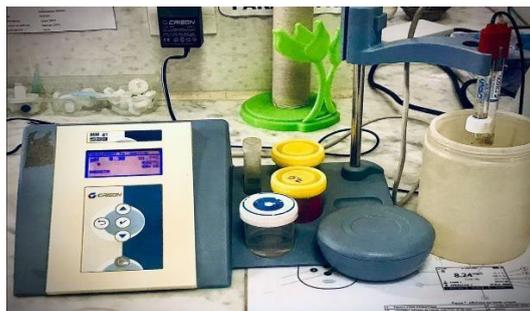
**Figure 10.** Appareil multiparamètres servant de mesurer la température, le pH, et la conductivité (Cliché Fofana, 2024)
