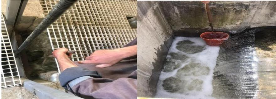
**Figure 8.** Prélèvement d'échantillons d'eau à l'entrée (gauche) et à la sortie (droite) de la STEP de Sidi Ali Lebhar (Clichés Fofana, 2024)
