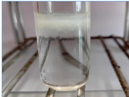
Figure 15 : Formation de cristallites d'oxalate de calcium sous forme d'un trouble blanc
