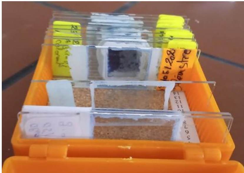
Figure 14 : lames préparées, lutées avec du vernis à ongle pour les conservées en vue d'observation ultérieure (Mouhoune/ Hafhouf, 2024).
