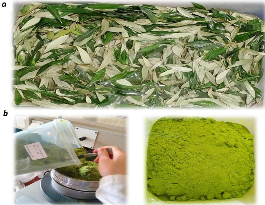
**Figure 12** : Lavage et séchage des feuilles d'*Olea europaea* L. (a), puis réduites en poudre, tamisées et conservées au congélateur avant utilisation (b).
