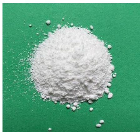
Figure II. 8: Poudre récupérée après le recuit.
