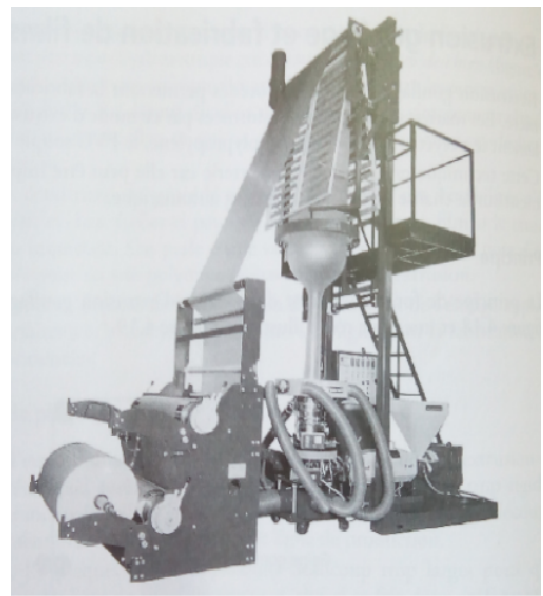
FIGURE 1.3 – Photo d'une ligne d'extrusion gonflage
