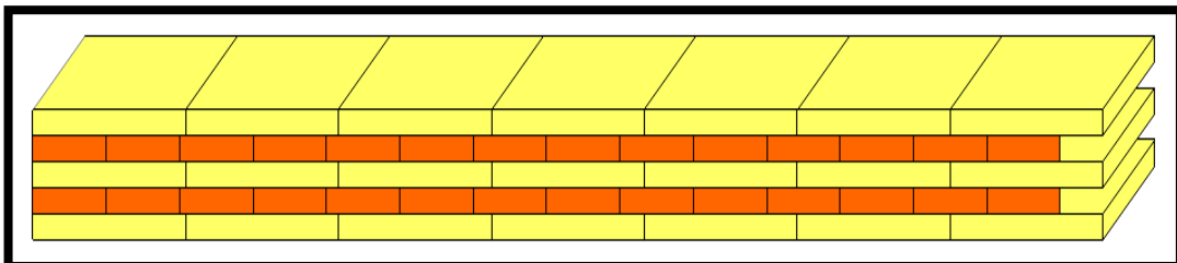
Figure 3.24: Appareillage Français sur les parties sud-ouest et sud-est, Source : auteurs 2016
