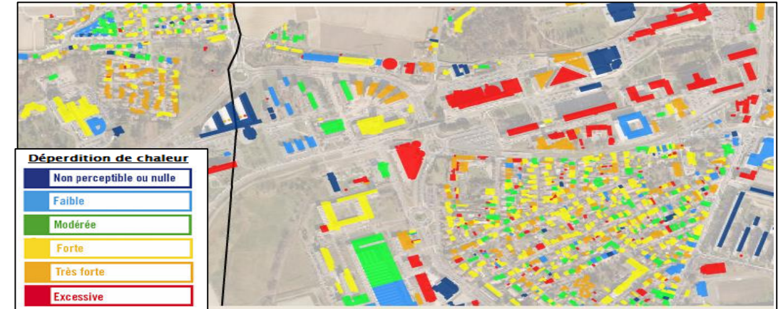
Figure 45 : La performance énergétique vue du ciel à l'aide d'une caméra infrarouge. (Source : J.LOPEZ, B.CARRERE, 2014, p 15.)
