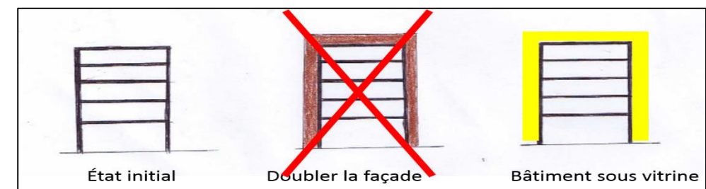
Figure 55 : réflexion adoptée pour le projet de réhabilitation. (Source : J.LOPEZ, B.CARRERE, 2014, p 38 repris par les auteurs, 2016.)
