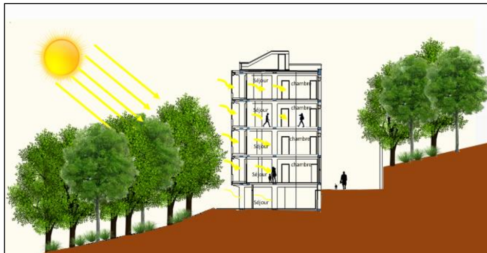
Figure 147: Coupe de l'ensoleillement des espaces intérieurs en hiver. (Source : auteurs, 2016)
