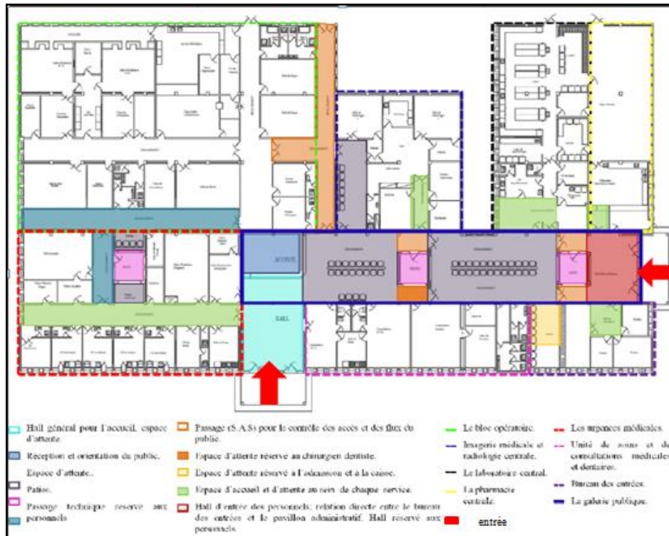
Figure 50 : Schéma présentant les espaces d'accueil du service des urgences Médico-chirurgicales à l'hôpital d'Ain Azel. Source : (Bouandes ; 2012)
