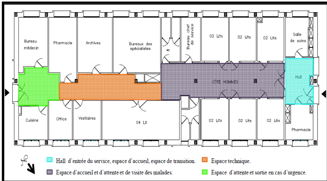
Figure 103 :schéma représentant la répartition spatiale du service de médecine interne femme, CHU de Sétif. Source : (Bouandes, 2012).
