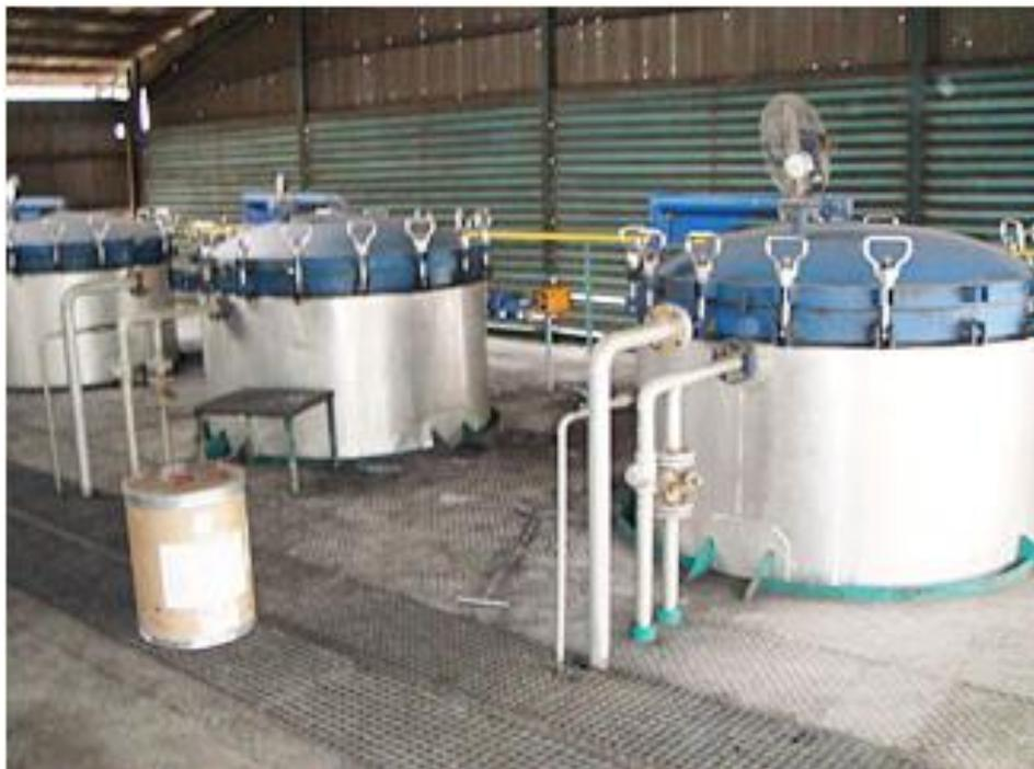
**Figure III.1 :** Filtre à précouche « NIAGARA ».
