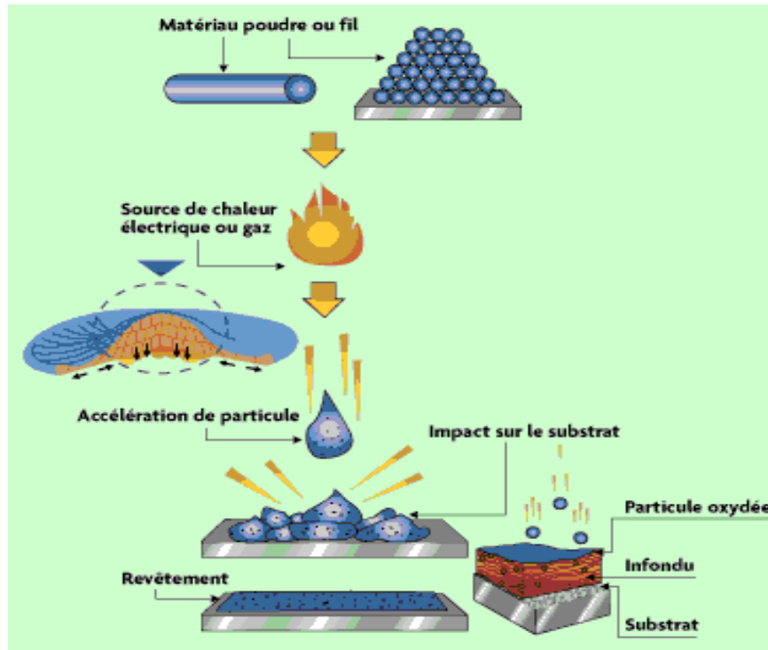
Figure I- 1: le procédé de projection thermique
