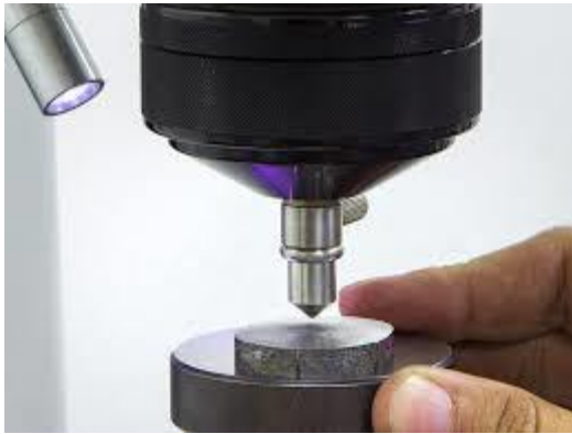
Figure II- 10: image représentative du principe de dureté
