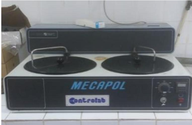
**Figure II.3 :** Polisseuse mécanique.
