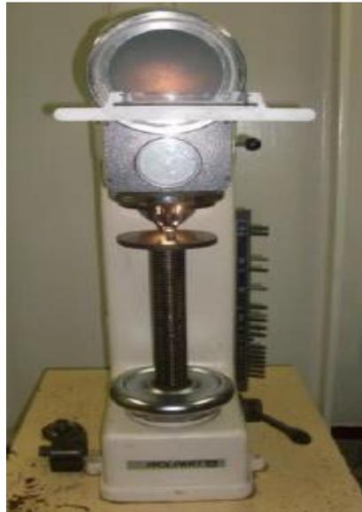
**Figure II.6 :** Machine de dureté universelle TYPE Diastor 2RC.
