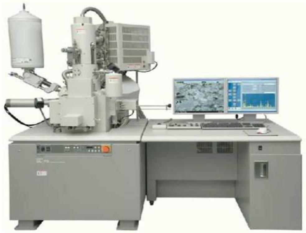
**Figure II.5 :** microscope électronique à balayage (MEB).
