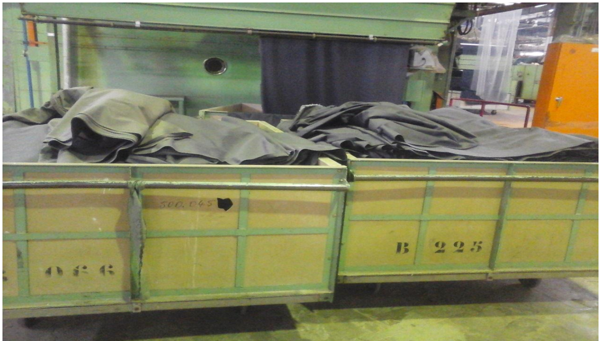
Photos n°02 : cette photo nous montre la manutention des charges lourdes qui sont portées manuellement, ce qui provoque le risque de TMS.
