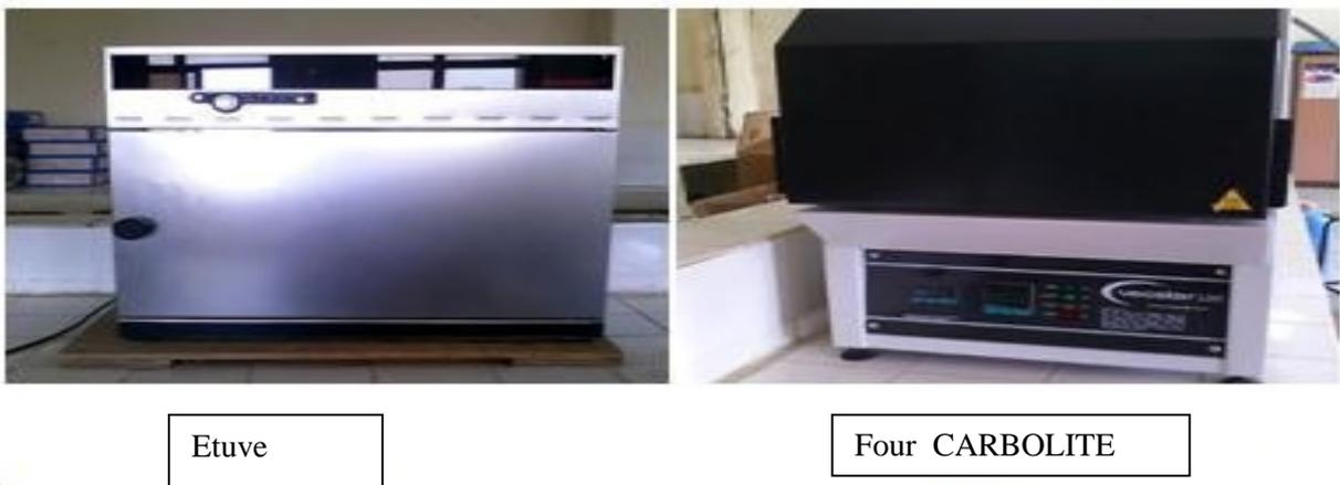
**Figure III.9 :** Photo d'une étuve et d'un four pour le frittage des pièces élaborer.
