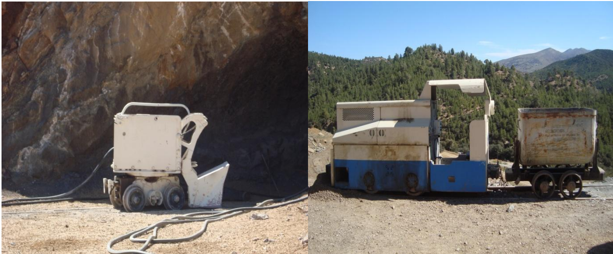
Figure III.8 : Pelle chargeuse sur rail et une wagonnette tractée par un locotracteur.
