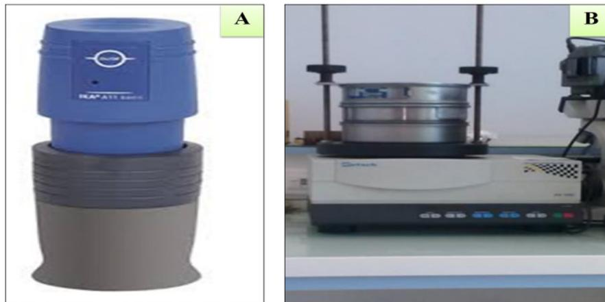
**Figure 6.** Photographie du broyeur électrique (A), tamiseur automatique (B)
