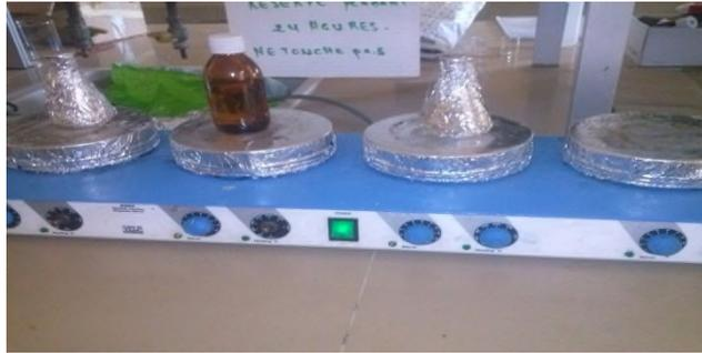
**Figure 7.** Prototype utilisé pour l'extraction par solvant assisté par agitateur magnétique.
