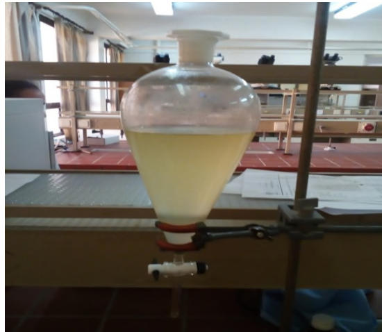
Figure8 : Photo originale d'ampoule à décanter contenant la phase aqueuse et les huiles essentielles.
