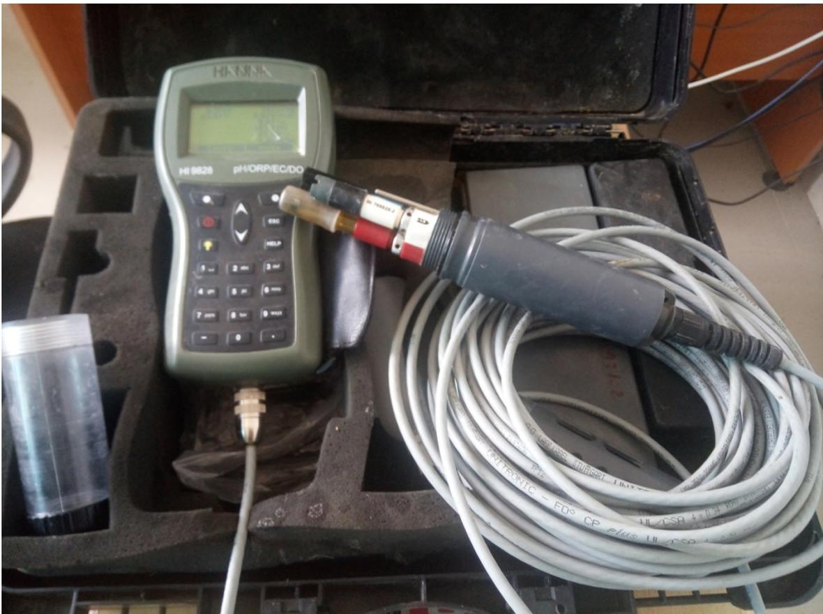
**Figure N°12 :** multi paramètres de terrain utilisé pendant les sorties sur le terrain.
