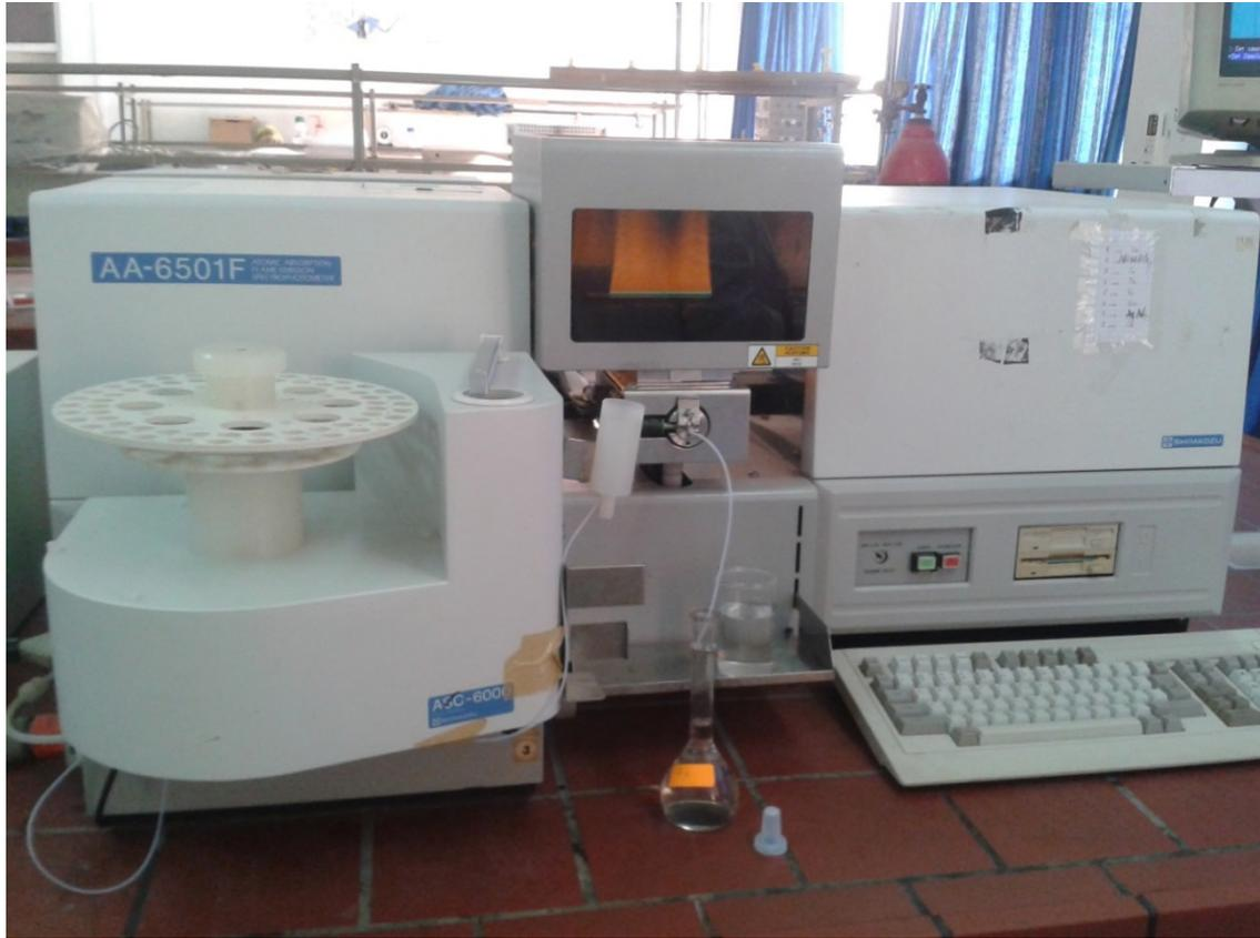
**Figure N°13 :** spectrométrie d'absorption atomique (SAA) utilisé pour réaliser le dosage de l'étude.
