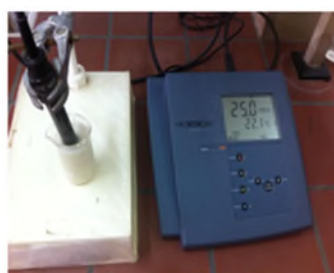
Fig. IV. 3: Appareil de mesure de la conductivité volumique des solutions polluantes (Conductimètre)
