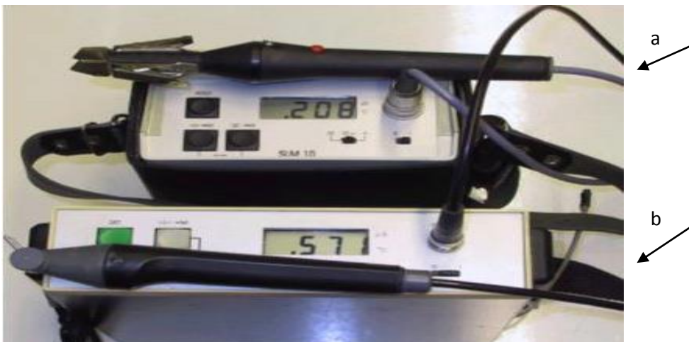
Fig. III. 2: Dispositif allemand de surveillance de la sévérité de pollution
