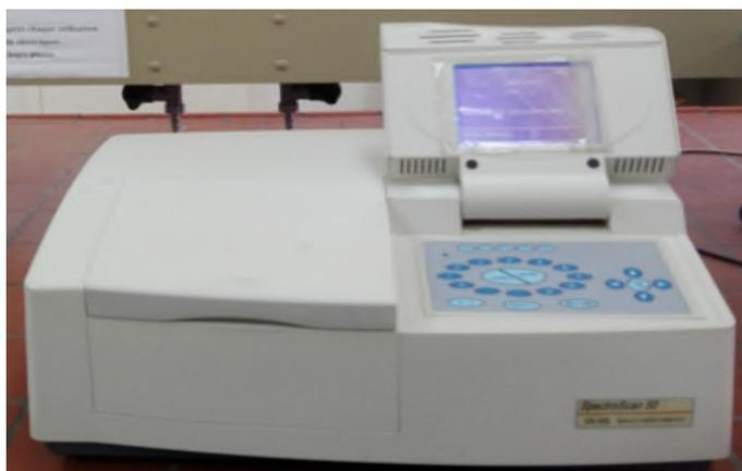
**Figure III.10:** l'appareil d'analyse ultraviolet
