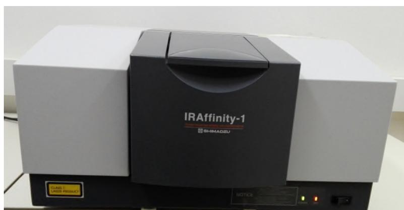
**Figure III.9 :** Photo de l'appareil infrarouge
