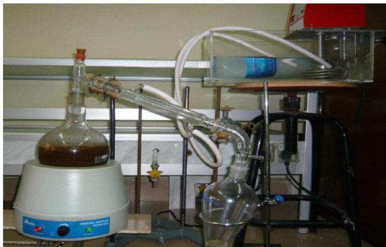
Figure 14 : Montage d'Hydrodistillation Clevenger
