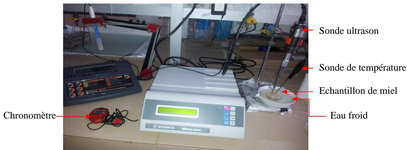
**Figure 9:** Dispositif pour le traitement de liquéfaction du miel.
