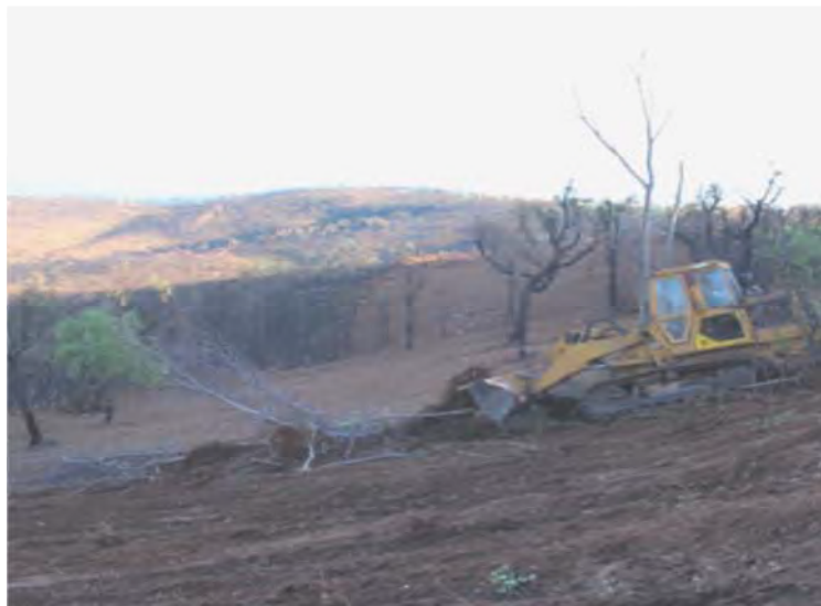
Figure 15 : Image de Dessouchage au riper.
