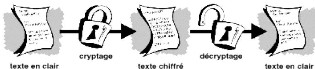
Figure 1 : chiffrement et déchiffrement
