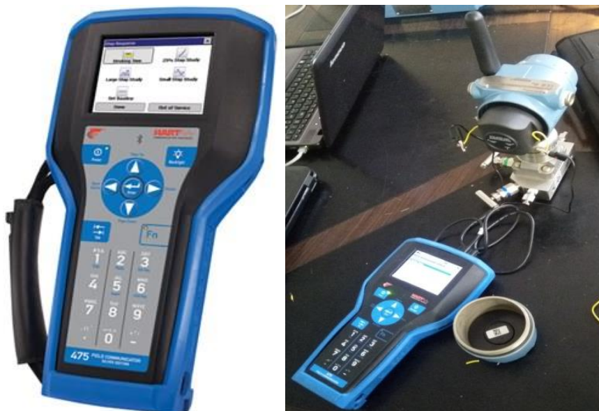
Figure 4.11 Branchement du capteur avec le HART Communicator
