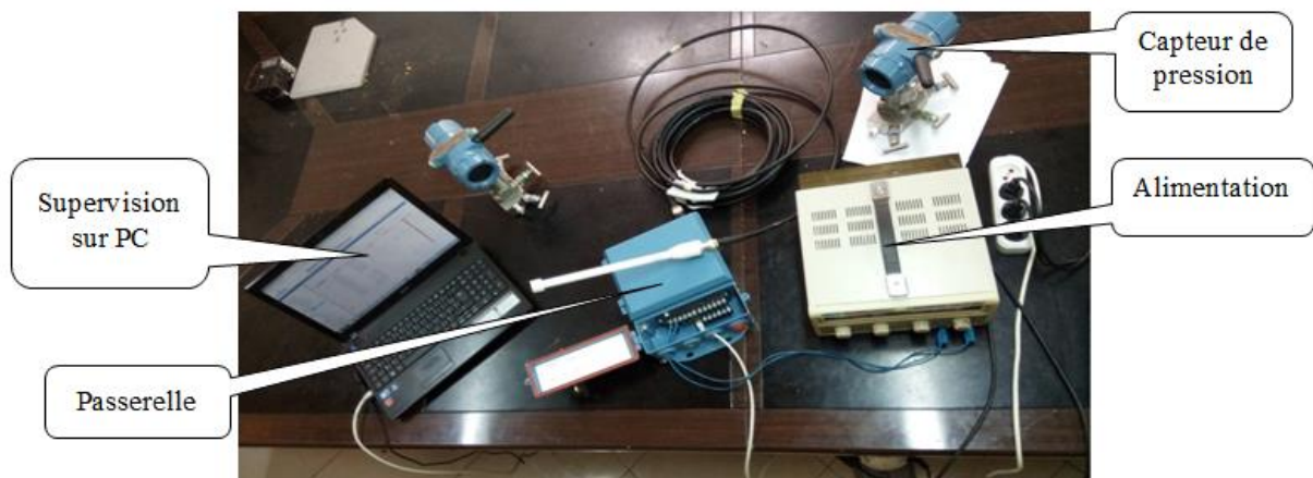
Figure 4.15 Configuration du réseau de capteurs
