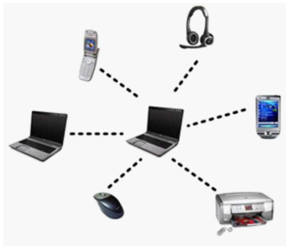
Fig. 1.1- Topologie du réseau Personnel [2].
