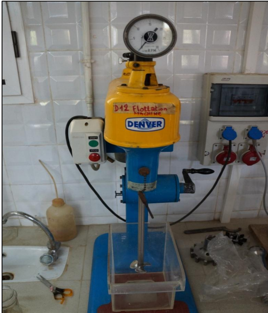
Figure III.5 : Photo d'une cellule de flottation DENVER.
