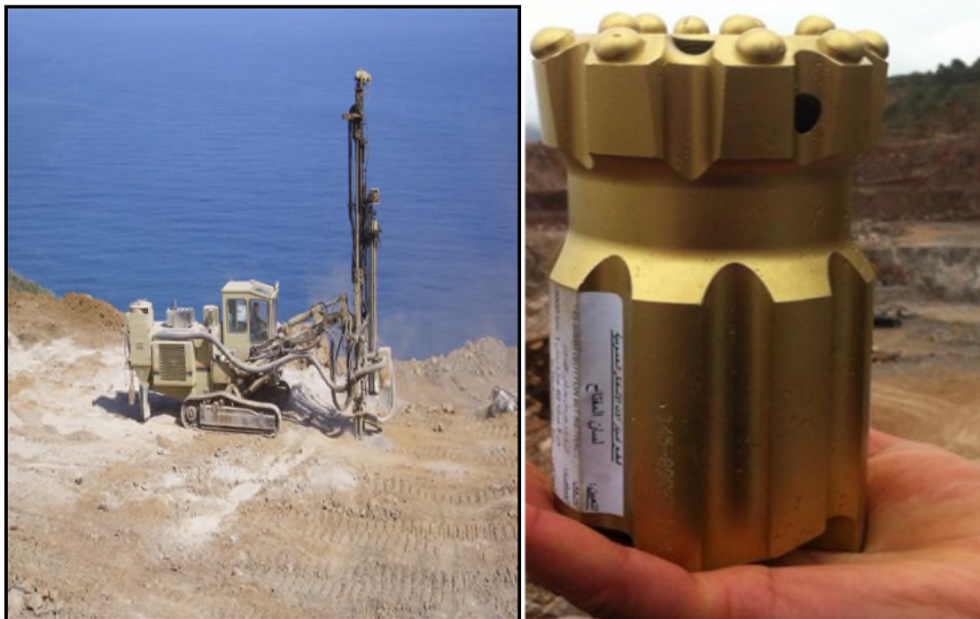
Figure VII.1 : Type de sondeuse et de taillant utilisé dans la carrière d'Adrar Oufernou.
