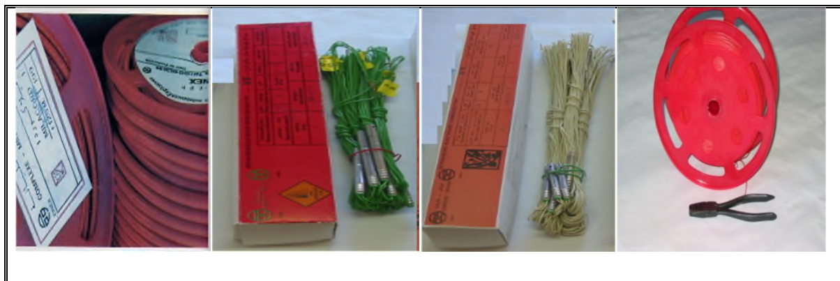
Figure VI.3 : Les accessoires de tir (cordant détonant, les détonateurs, le fil de tir). [15]
