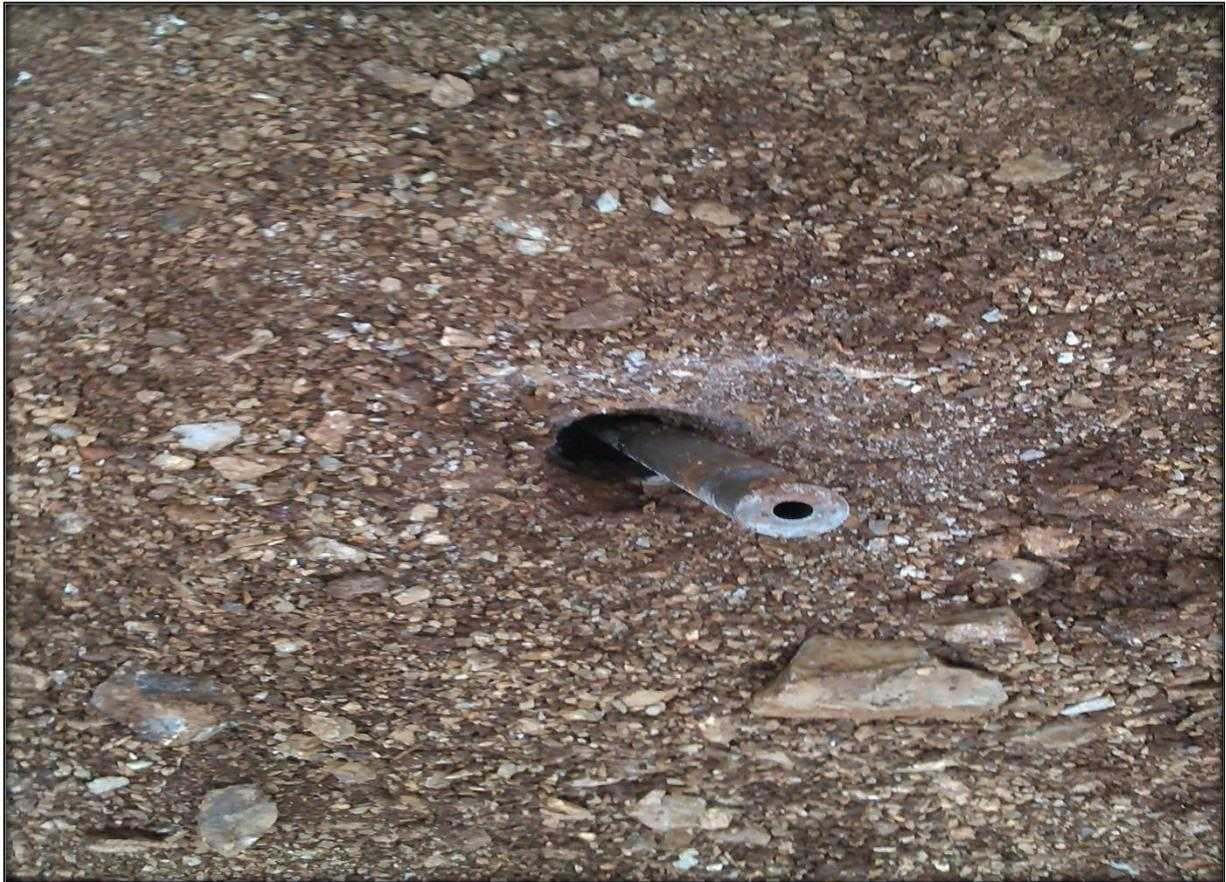
**Annexe I.5:** Cisaillement de tige de la sondeuse au fond du trou.
