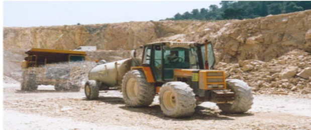
Figure III.11 l'arrosage des voies de transport.
