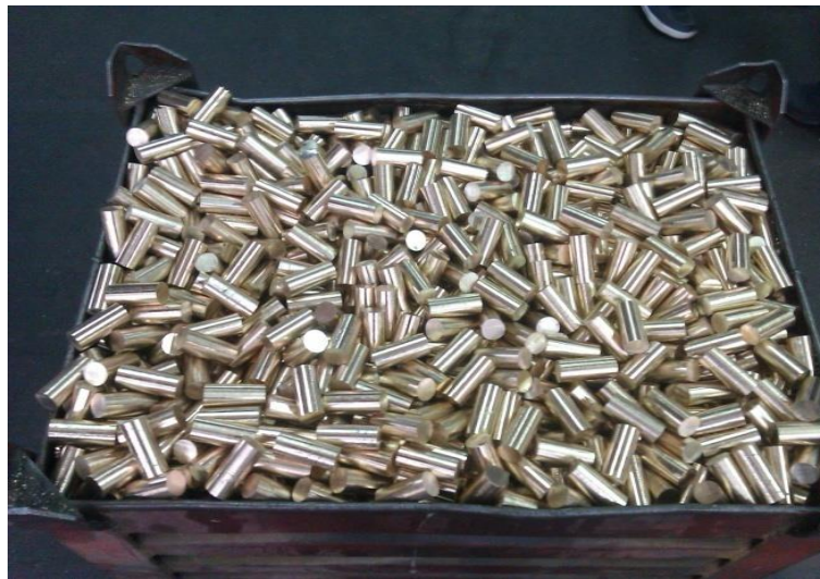
Figure II.2 : matière première de la filial SANIAK (Laiton Zn39Cu51Pb3). [1]
