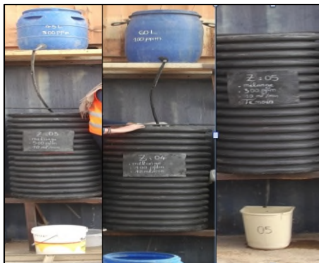
Figure III.8: Colonnes de test de lixiviation Z06, Z05 et Z07 (étude de l'effet de l'arrosage). [Source: Photo prise]
