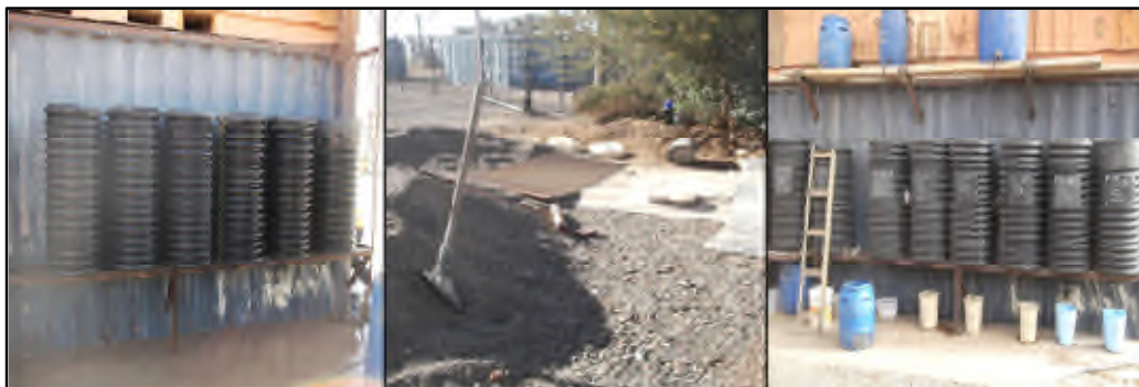
Figure F.5: Le chargement du minerai, le système d'arrosage et la récupération de lixiviat.
