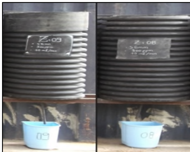
Figure III.6: Colonnes de test de lixiviation Z08 et Z09 (étude de l'effet de la granulométrie). [Source: Photo prise]
