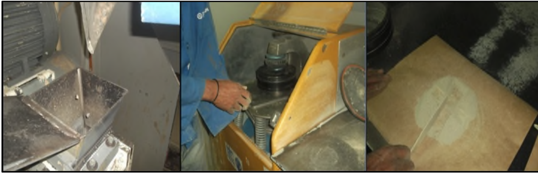
Figure III.12: Préparation mécanique (concassage, broyage et quartage).[Source: Photo prise]
