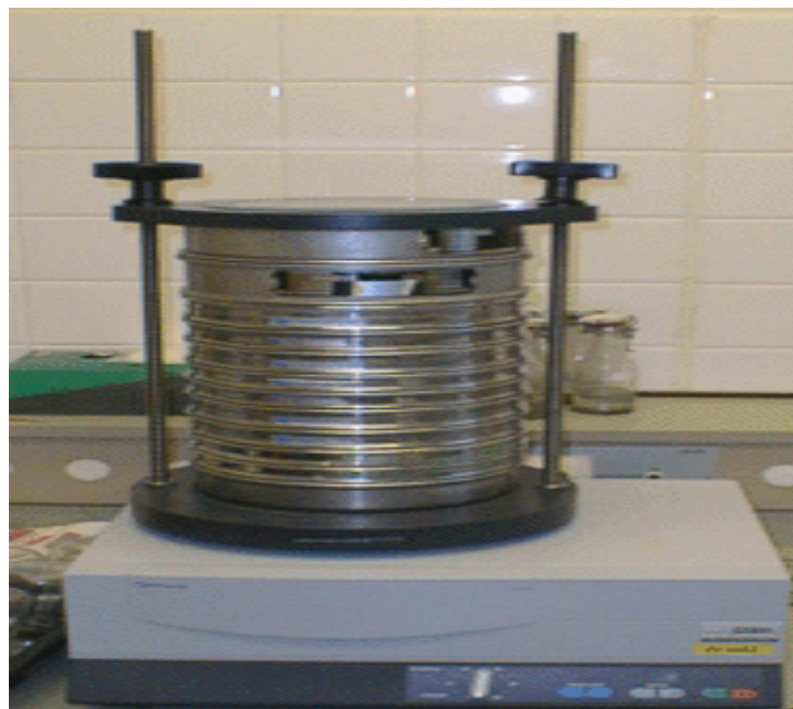
Figure II.5. : le tamisage du kaolin KT3B (photo graphique originale 04/04/2014)
