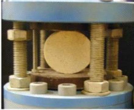
**Figure II.11-**Dispositif expérimental (Essai Brésilien). [21]
