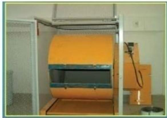
**Figure II.18-** Machine Los Angeles (le diamètre du tambour est d'environ 71 cm). [11]
