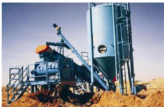
**Figure V.5 :** Mixeur d'inertage
