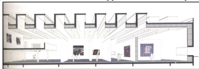
Figure 37 : Le dispositif en Lanterneau.
