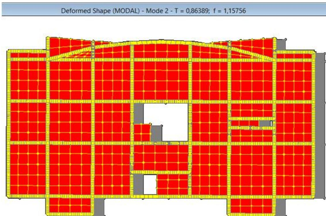
Figure IV.4 2<sup>ème</sup> mode de déformation (translation suivant x-x)
