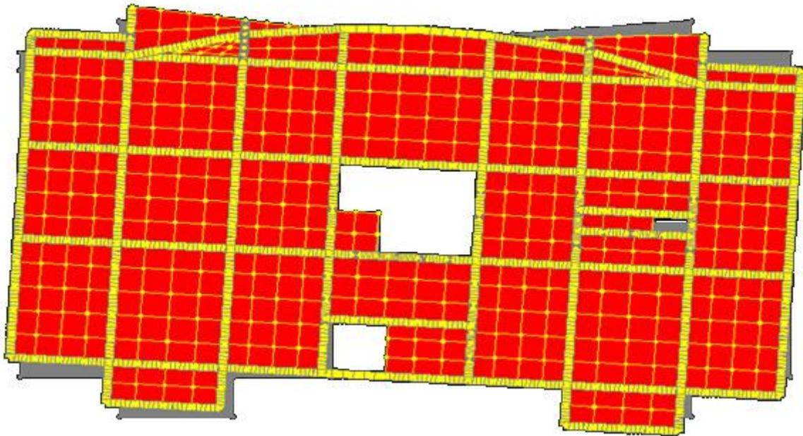
Figure IV.5 3<sup>ème</sup> mode de déformation (torsion au tour de z-z)
