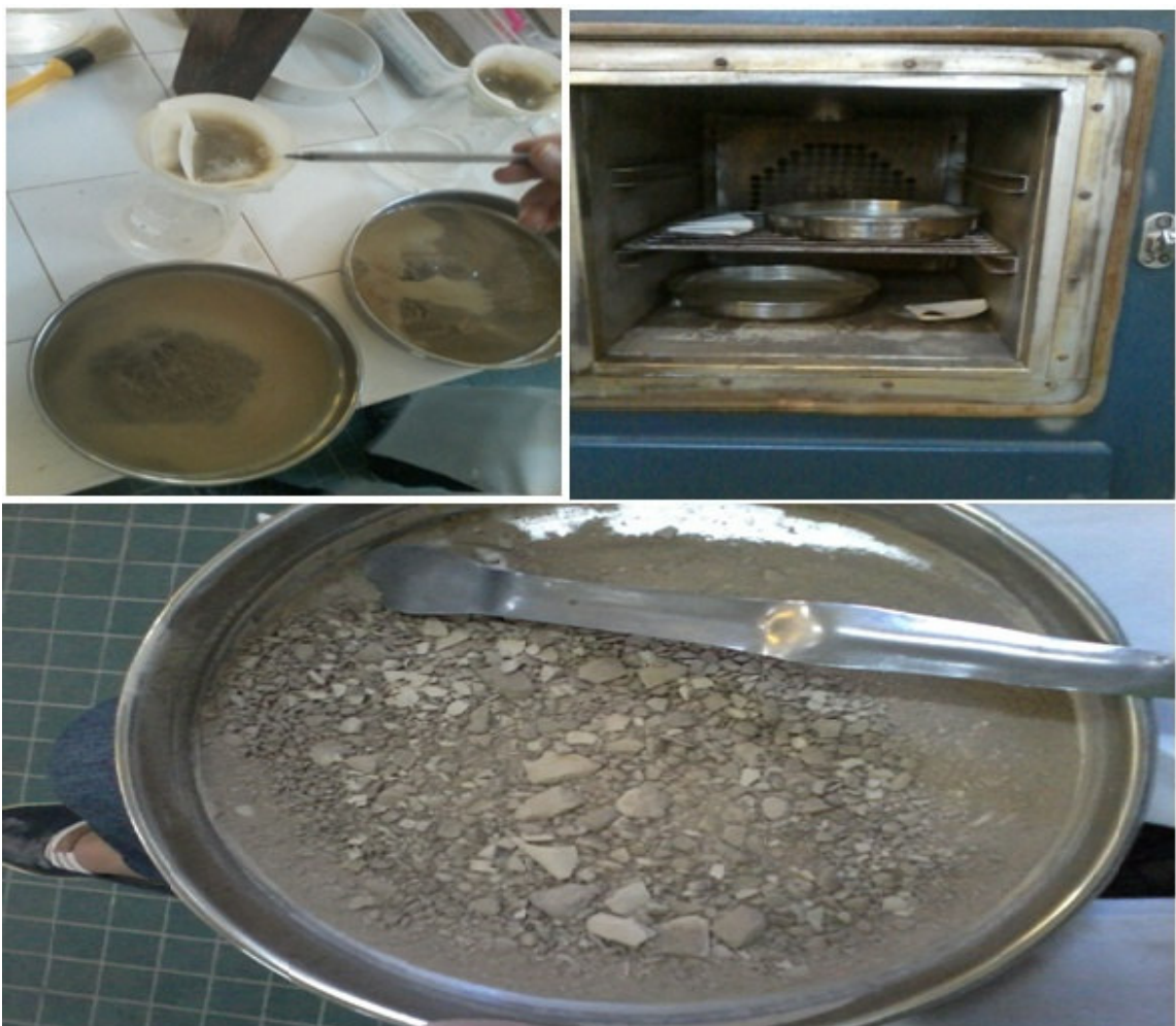
Figure III.5 : Filtration, Séchage et Dé-colmatage des échantillons à étudiés.
