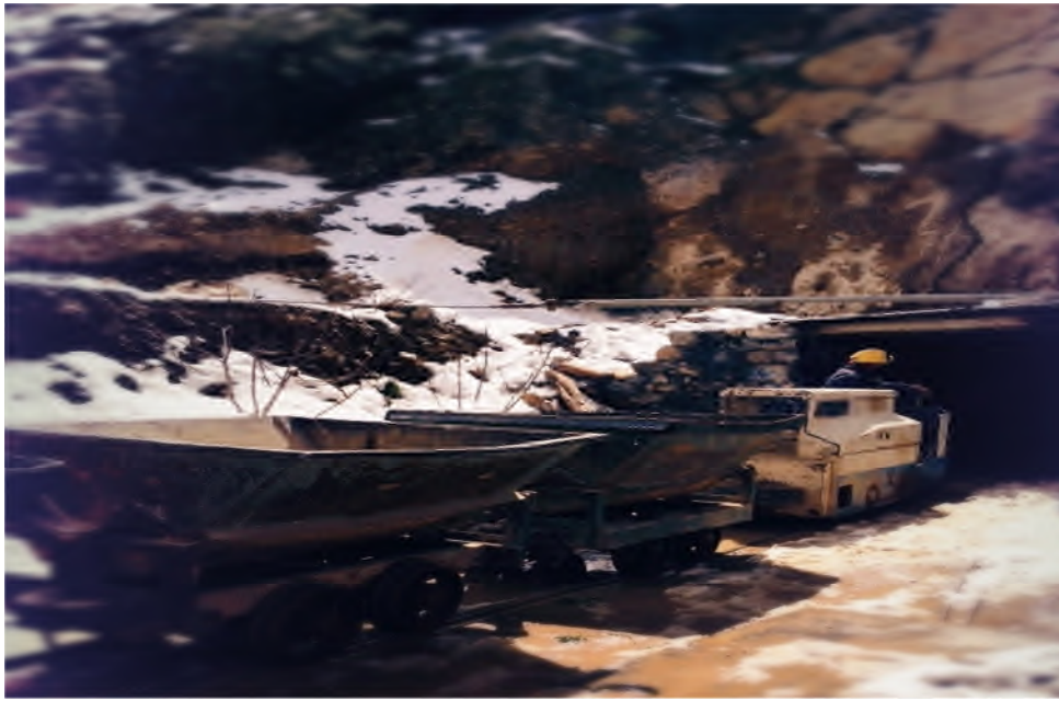
Figure II.8: locotracteur avec wagonnets sur rail pour le transport à l'intérieur de la mine, état actuel.
