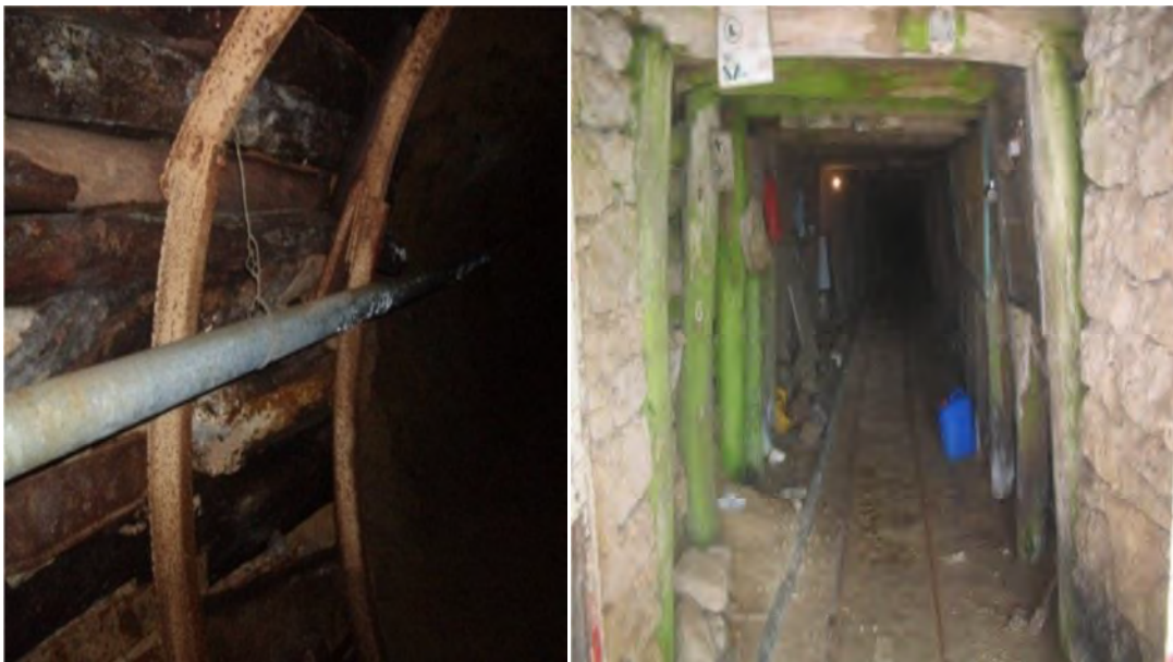
Figure II.11 : Soutènement dans le gisement Lakhdar [1].
