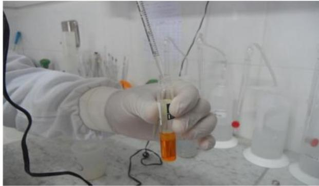
**Figure n° 8 :** Cuve pour analyse de la DCO
