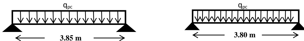
Figure III.39 : Schéma statique des poutres chaînées.
