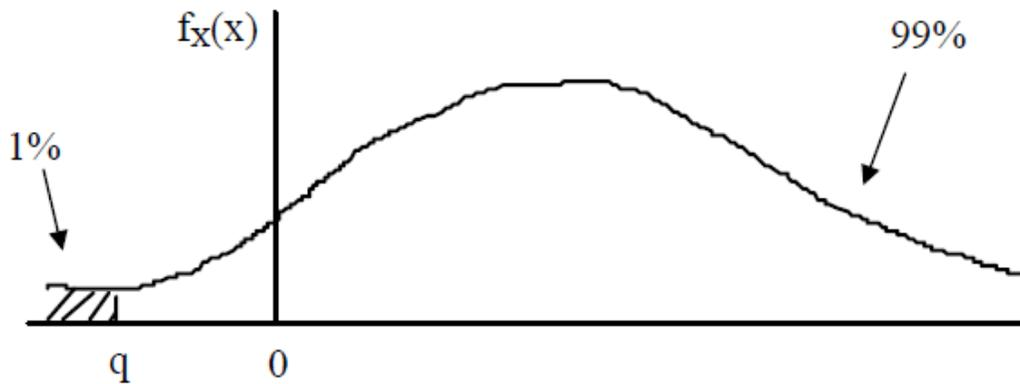
FIG. 1.1 – Schéma explicatif de quantile
