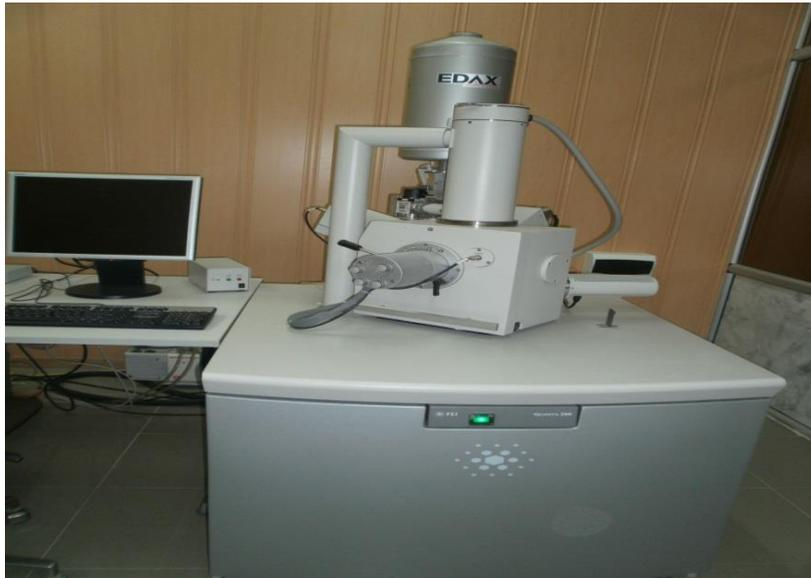
**Figure (II-4) :** Appareil microscope électronique à balayage
