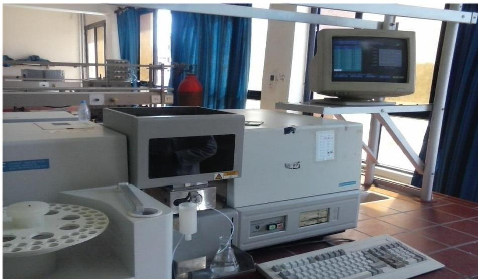
**Figure ( II-5) :** Appareil Spectrophotométrie d'absorption atomique (SAA) utilisée.
