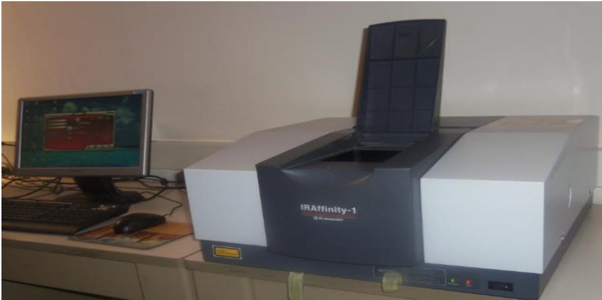
**Figure (II-3) :** Appareil Spectroscopie Infrarouge
