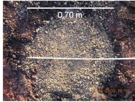
Figure 6-1 Coupe d'une colonne ballastée
