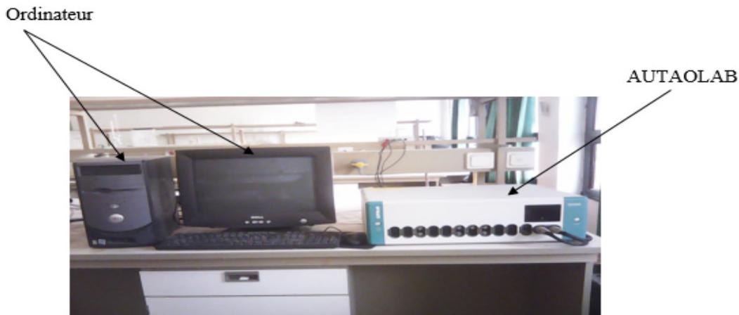
Figure II-5 : Représentation de l'appareillage électronique utilisé (AUTOLAB).
