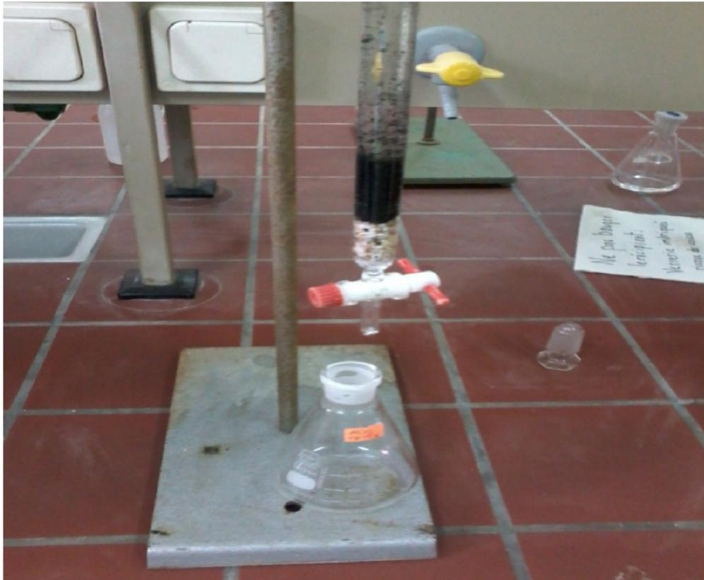
Figure III-2 : filtration sur charbon actif granulé
