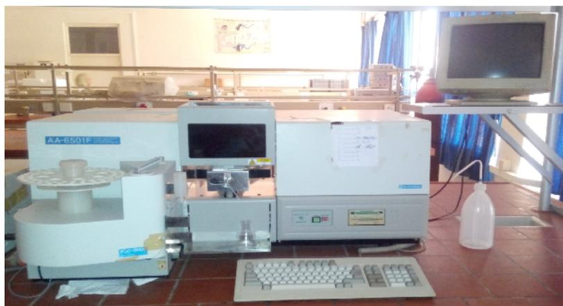
Figure III-3. Spectrophotomètre d'absorption atomique SHIMADZU AA-6501F.
