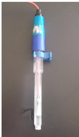
Fig.2.3. Photographie de l'électrode de référence
